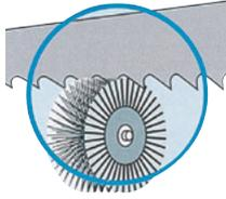
ブラシの先端がプレートの断面に当たるように調整します。
