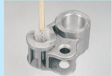
研磨作業は研磨物円筒内にコンデンサーブラシを回転させずに約1/3~1/2差し込み、その後予め設定した回転数で回転させて下さい。
