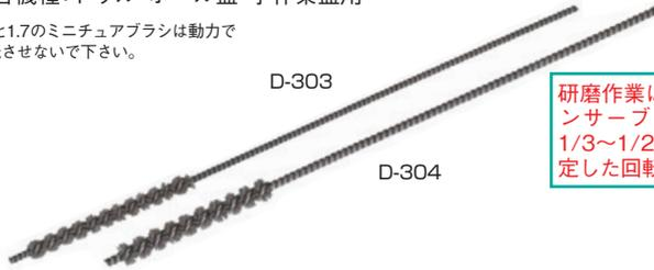
研磨作業は研磨物円筒内にコンデンサーブラシを回転させずに約1/3~1/2差し込み、その後予め設定した回転数で回転させて下さい。
